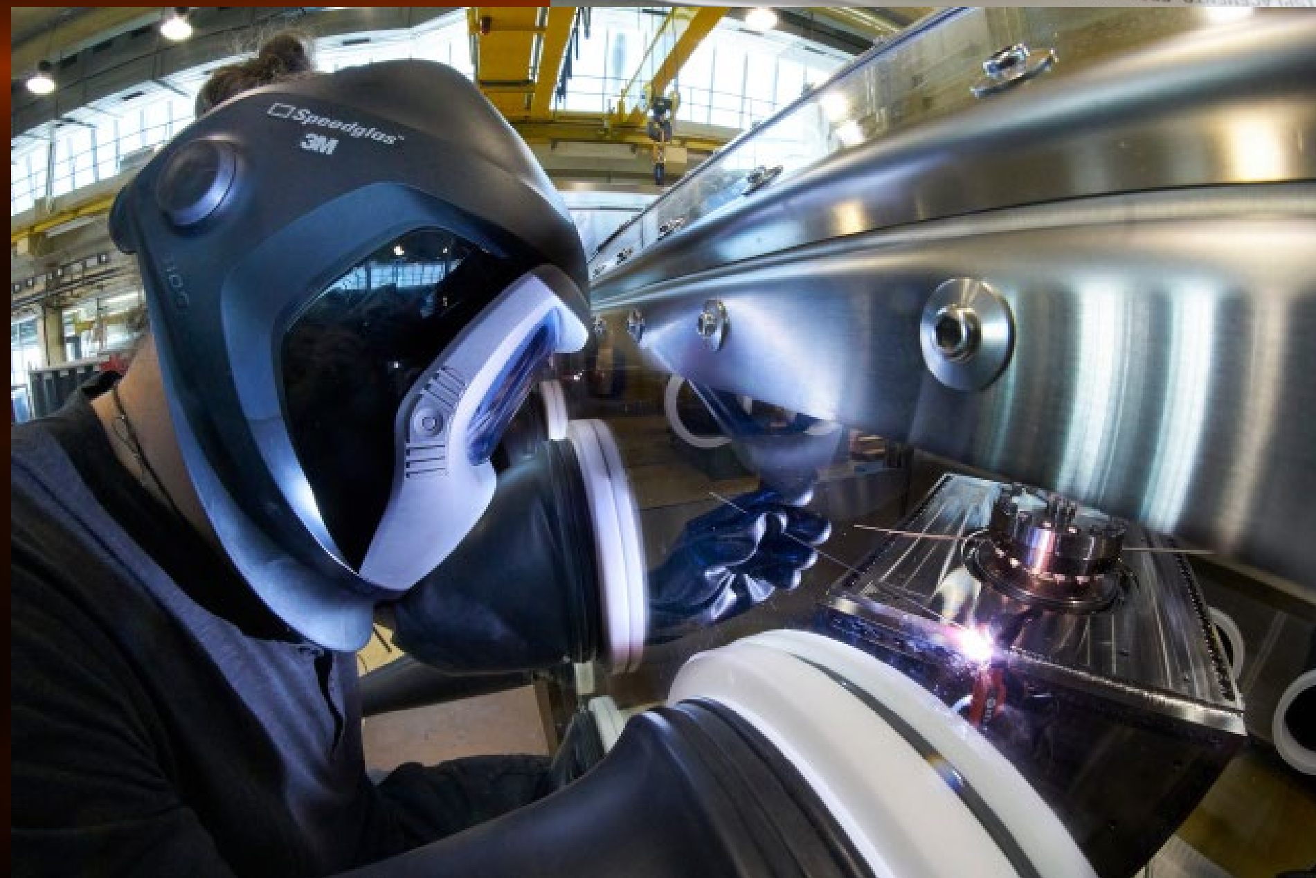
● Soldadura de una de las cavidades de cangrejo, esenciales para el buen desempeño de HiLumi. Foto: CERN.
